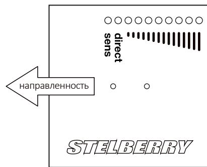
**Регулировка направленности и чувствительности микрофона**
