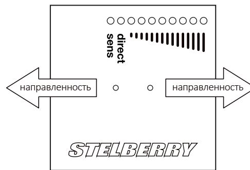
**Регулировка направленности и чувствительности микрофона**
