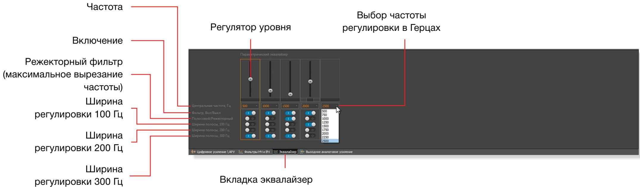
Параметрический эквалайзер позволяет ослабить или усилить выбранную частоту, с заданной шириной регулировки.
