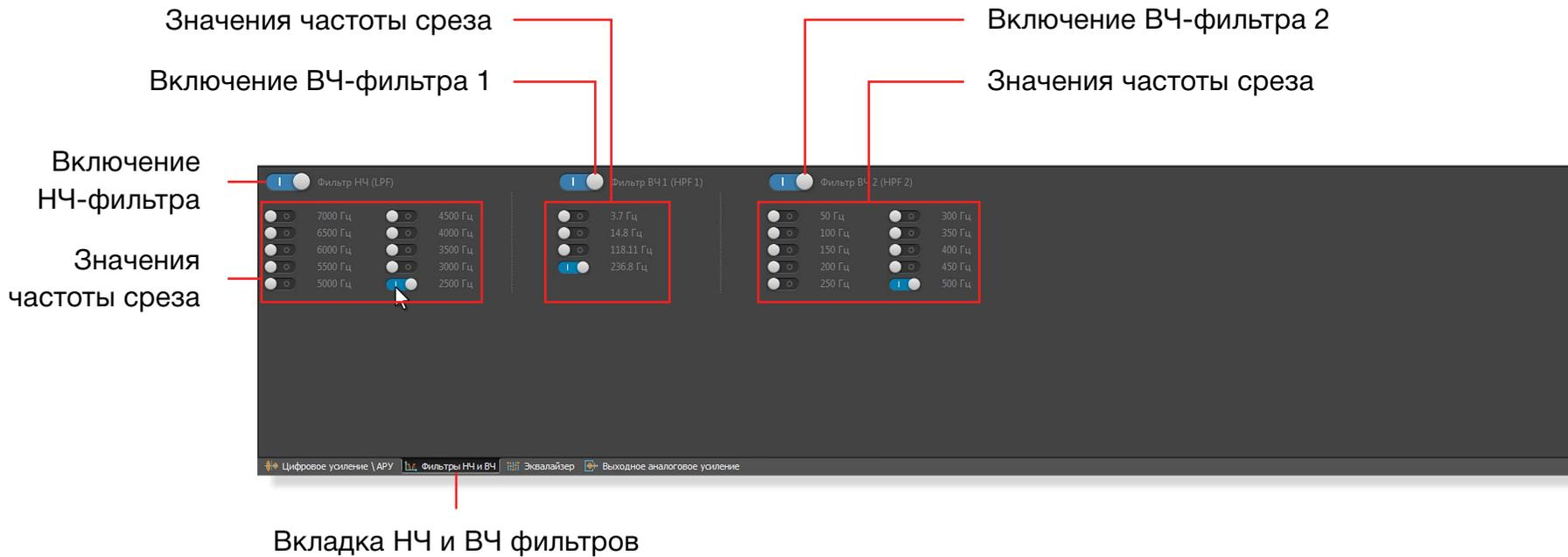
Вкладка НЧ и ВЧ фильтров содержит 1 фильтр низких частот и 2 фильтра высоких частот. Фильтры позволяют ослабить низкие и высокие частоты, что в результате даст высокую разборчивость речи, а также будут исключены лишние звуки. Для включения любого из фильтров, необходимо кликнуть по соответствующему переключателю.
