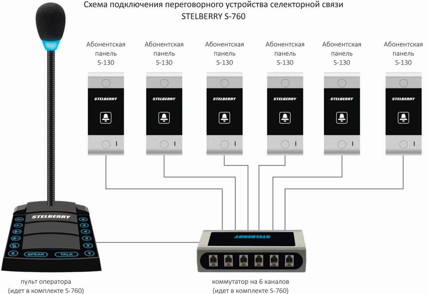
В переговорных устройствах STELBERRY S-740 и STELBERRY S-760, предусмотрена индивидуальная настройка громкости для каждого канала. При выборе канала и регулировке, автоматически запоминается последнее значение громкости, обеспечивая одинаковое восприятие речи собеседников, вне зависимости от их удаленности.
